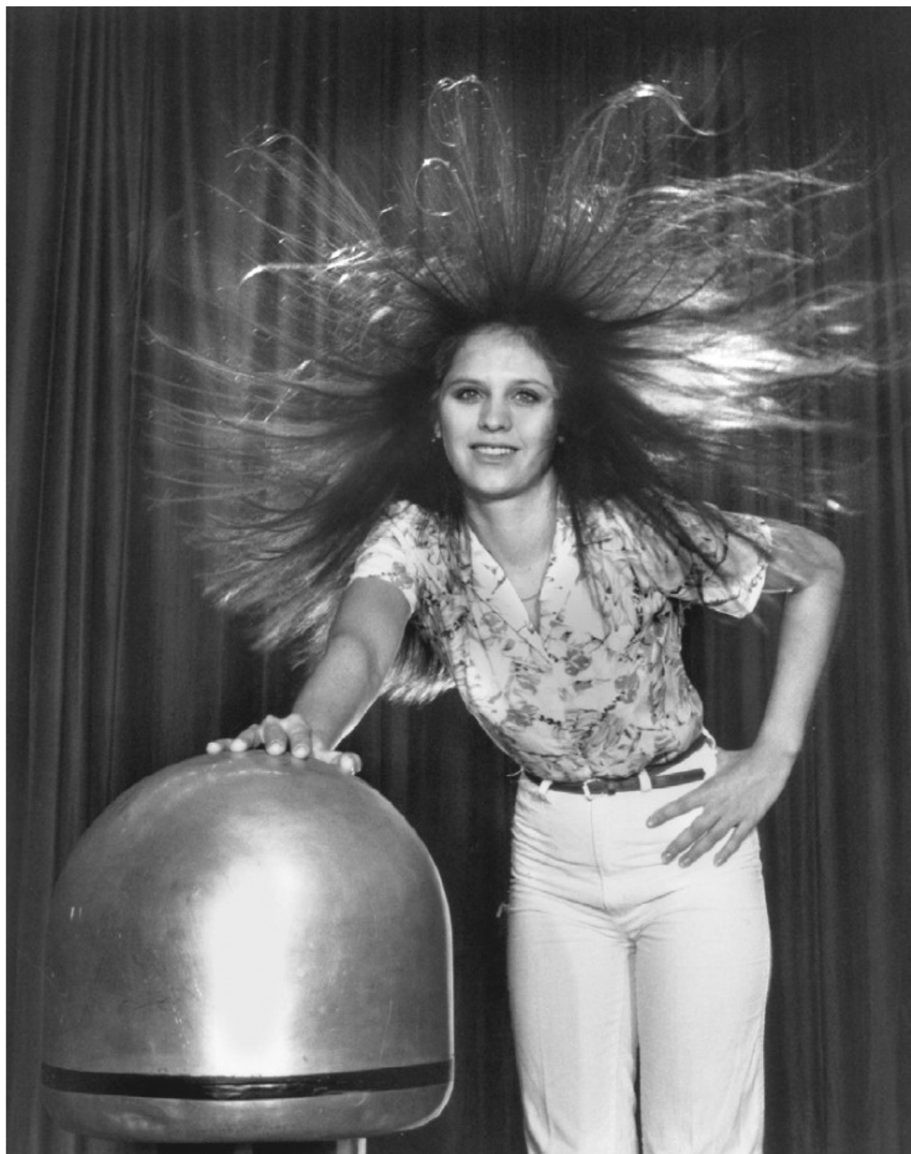
图3.2 把手放到范德格拉夫起电机上导致头发竖起 来源：美国科学与能量博物馆中的范德格拉夫起电机，位于美国田纳西州橡树岭。
